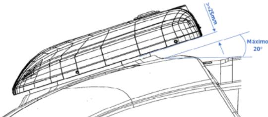
**1.0:** Deve haver uma distância mínima de 25mm entre base do AC e a superfície do teto para que o ar possa entrar no condensador sem perder vazão.
