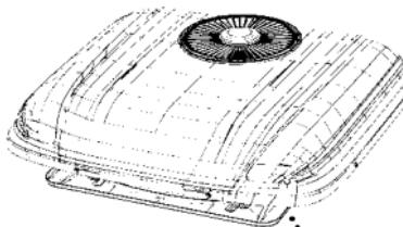
La entrada de aire está detrás y debajo del aparato. Limpie por debajo, entre el techo y la base del aparato. El espacio es limitado (mínimo 25 mm).
