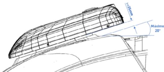
**1.0:** Debe haber una distancia mínima de 25 mm entre la base del aire acondicionado y la superficie del techo para que el aire pueda entrar en el condensador sin perder flujo.
